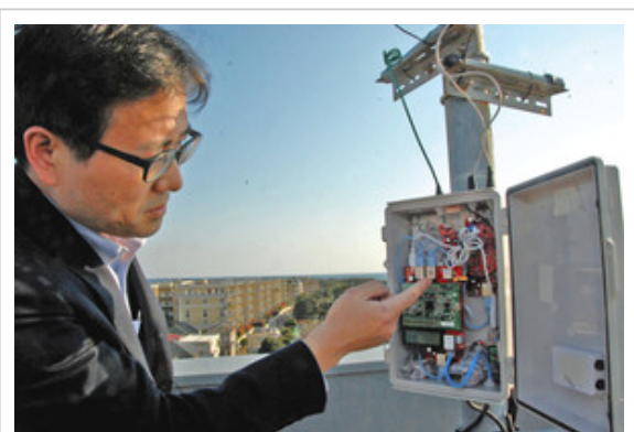
湘南工科大の屋上に設置されている落雷情報の受信機
